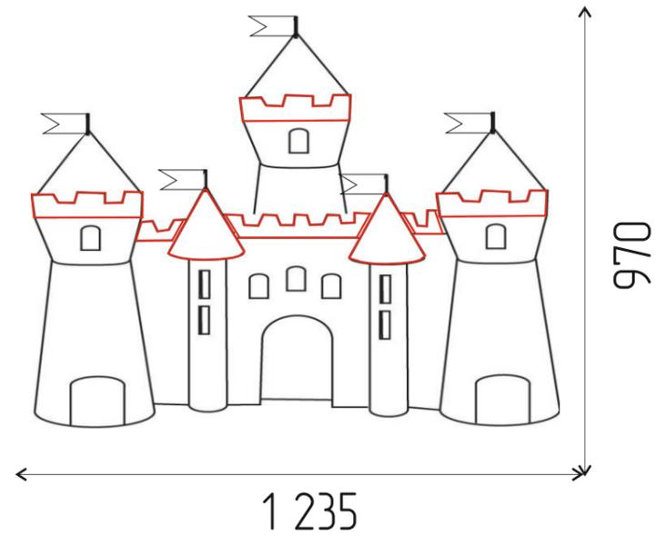
Замок изготавливаются из гипсокартонного листа 12 мм., в два слоя. Вырезается по шаблону.
